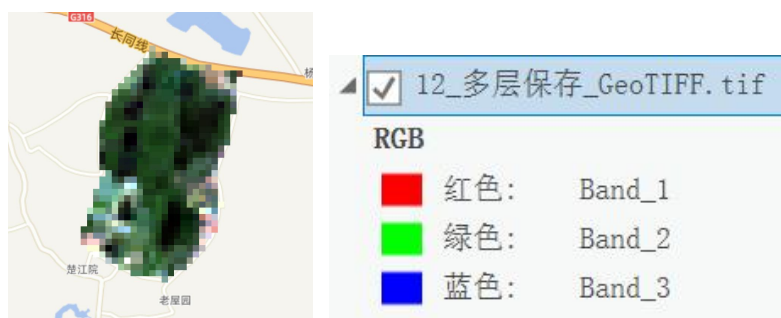
图 3.5.1-1 储存的 GeoTiff 格式的栅格数据（波段名称保留） 可见影像能正确显示，但是波段名称已经丢失。
