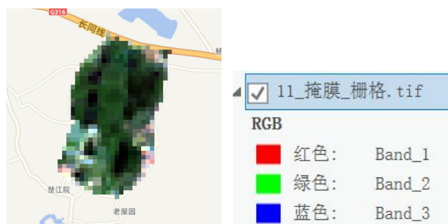
图 3.4.2-3 织娘院子的栅格影像在 GeoScene Rro 3.1 软件中加载的结果（真彩色显示，波段已经过抽取）
